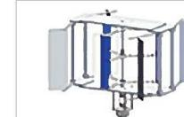
高効率小型ジャイロミル風力発電機は、神戸大学工学部名誉教授 菅原道久氏の風車の特許技術を採用し、従来のジャイロミル型風車の動翼フレードの一部に弾性体を使用しています。そうすることで、風が弱い時には発電効率を向上させることができ、強風時でも翼の回転を止めることがなく発電し続けることが可能になります。本事業では商品化に向けて試作品を改造し、実証実験の基礎データとします。
