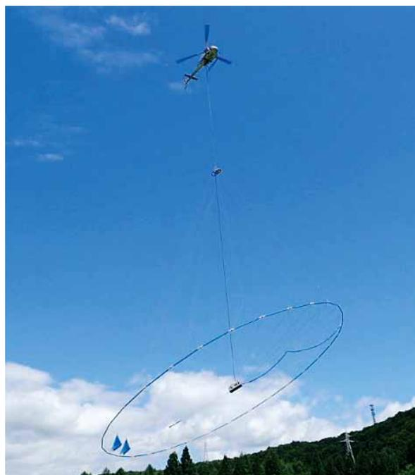
空中物理探査の試験状況
