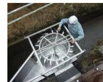
電気を使わない除塵機 設計製作(株)白竹鋼鉄工業所 特許権者いづものかたち(株)
