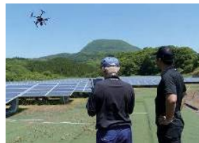
柳井電気工業(株)の太陽光発電検査ドローンによるパネル検査
