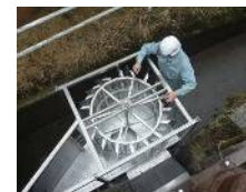
電気を使わない除塵機 設計製作:(株)臼杵鋼鉄工業所 特許権者:つくものかたち(株)
