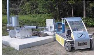
いくつものかたち(株)による小水力発電と竹バイオマス発電の電気を小型EVに給電して地域活用する実証事業
